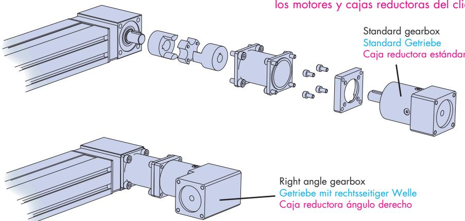
Werkseitig angebrachte Motoren stellen eine kostengünstige Lösung dar, geeignet auch bei hohen Geschwindigkeiten und Stößen. Hepco liefert eine Vielzahl von Motoren, optional auch mit Haltebremse, Encoder zur Positionierung und Umrichter zur Spannungsversorgung und Steuerung.
