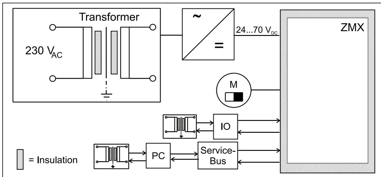
Fig. 8: ZMX<sup>+</sup> Insulation
